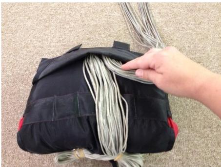
4. INSERT THE MAGNETIC TABS INTO THE POCKETS AND ROTATE THE BAG BACK TO THE ORIGINAL POSITION.
