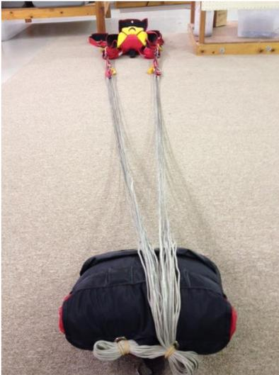
3. ROUTE THE LINES STRAIGHT DOWN THE CENTER OF THE POUCH BETWEEN THE MAGNETS AND THEN S-FOLD THE LINES BACK AND FORTH.
